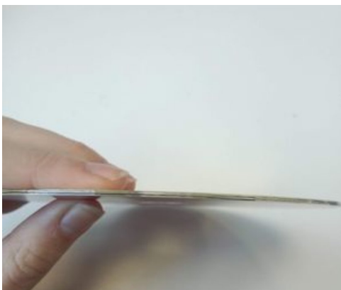
Het zij aanzicht van een dvd, waarbij zich een zichtbare naad in het midden bevindt
